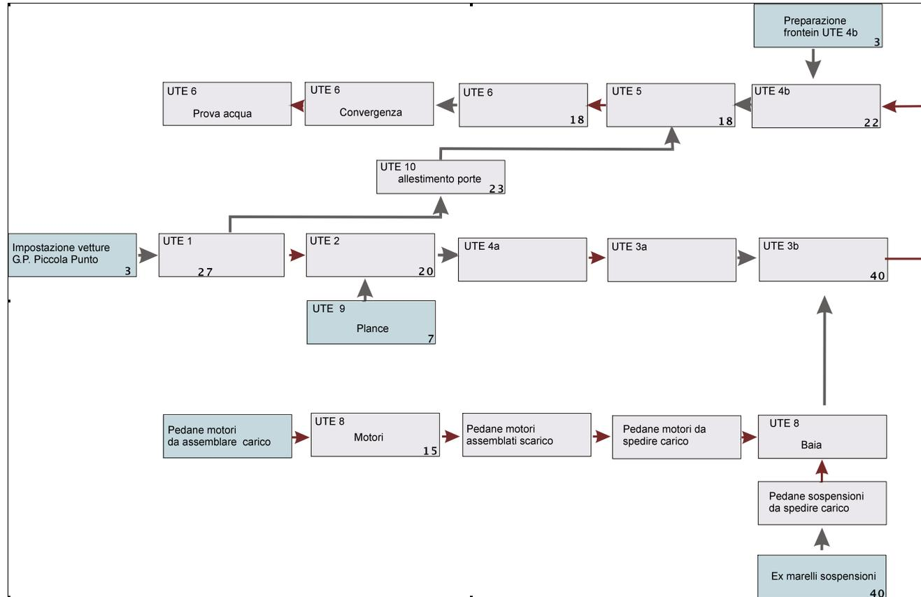
Figura 2 – Linea Montaggio Multipla
